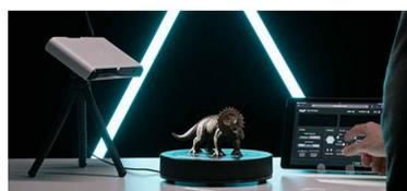
Un scanner 3D vous permet d'obtenir un modèle 3D d'un objet en vue de sa duplication, sa modification, ou son impression 3D.
