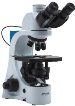
Tête : Binoculaire Objectifs : E-Plan Achromatiques 4x/0.10, 10x/0.25, 40x/0.65 et 100x/1.25 (Huile) Platine : 160 x 140 mm avec surplatine 78 x 54 mm à déplacement par courroie d'entraînement Dispositif CAL - Contrôle Automatique de Lumière Alimentation secteur externe
