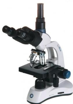
Tête : Trinoculaire inclinée à 45°, tournante sur 360° Objectifs : Achromatiques DIN 4x/ 0.10, 10x/0.25 et S60x/0.85 rétractable Platine : 123 x 119 mm avec surplatine réglable mécaniquement en X-Y Eclairage : à Diode électroluminescente LED de 1 Watt avec intensité réglable, batterie intégrée et alimentation externe sur transformateur inclus.
