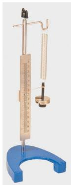
Appareil livré avec un support de masses... (10 masses de 10g)
