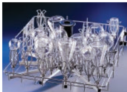
Chariot Injecteurs pour tubes à essais, centrifugation... Hauteur de Chargement 190 mm, 96 gicleurs de 2.5 x 110 mm..
