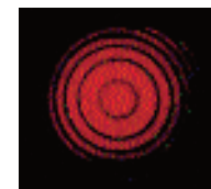
En mode Fabry-Perot, des franges d'interférence parfaitement espacées
