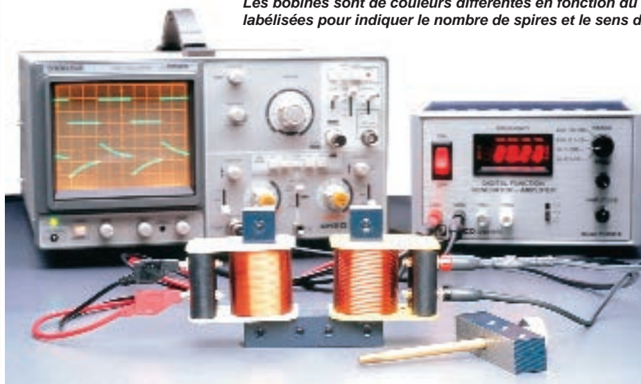
Théorie du Transformateur. Ensemble Complet présenté avec Générateur BF et Oscilloscope ou une Interface ExAO...
