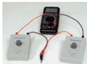
Exemple de résistances montées en série
