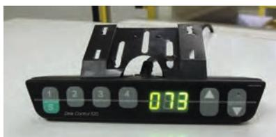
Les colonnes sont pilotées par un pupitre de commande fixé sous le plateau ou par télécommande radio-fréquence optionnelle.
