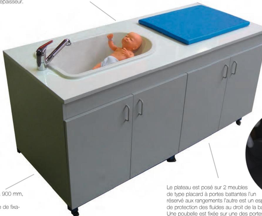
Une baignoire moulée est encastrée à l'extrémité droite du plateau. Les joints silicones assurent une parfaite étanchéité. Elle est équipée d'un mitigeur avec douche montée sur flexible. Un coussin à langer est posé sur la partie libre du plateau.
