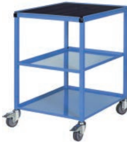
◀ Etabli Mobile TechnoMob Structure en Tôle mécanosoudée 20/10 ème Entretoises en U de 60 x 40 mm. 1 Plancher en Tôle d'acier de forte épaisseur. 1 Plateau en Multiplis de Hêtre de 40 mm. 4 Roulettes diamètre 160 mm dont 2 à frein Proposée en Largeur 1200 mm.
