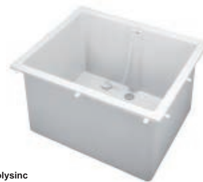
Cuve Vulcathène 560 x 460 mm - Polysinc Profondeur Utile 300 mm. Dimensions Utiles 500 x 400 mm Avec trop plein et Bonde surmoulée. Bouchon et Grille sont fournis avec la cuve. Chaînette (optionnelle)
